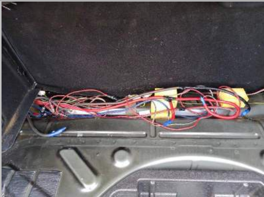
Loose sound wiring
